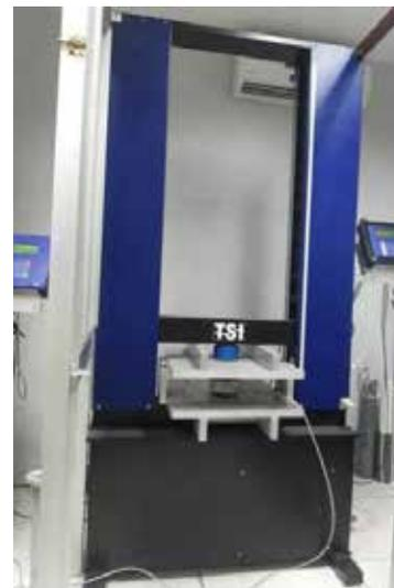
**Figura:** Medición de la fuerza generada por una máquina de ensayo a través de una celda de carga.
