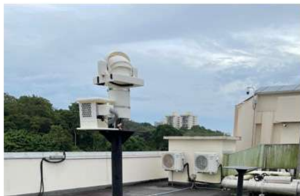
(b) Espectrómetro con controles, deshumidificadores, circuitería y funcionamiento a punto.
