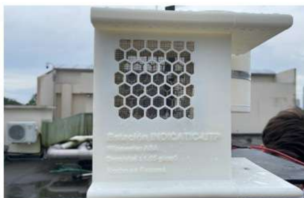
(d) Sistema de aire acondicionado con efecto Peltier para el trópico y conservaciones de sensores especializados.
